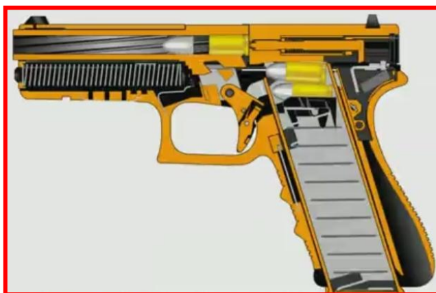
La partenza del colpo in una pistola semiautomatica
