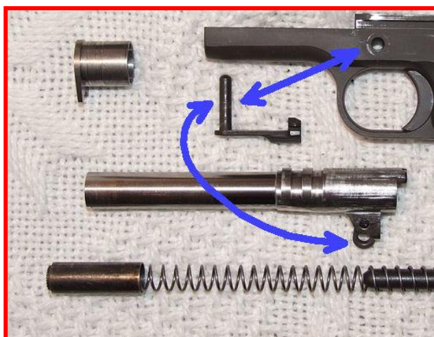
Il chiavistello inserito nel fusto vincolerà anche la bielletta della canna.
