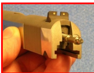
Il percussore al di fuori della sua sede ricavata nel carrello.
