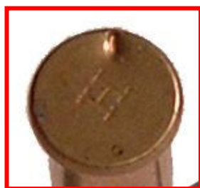
Bossolo di una munizione rimfire in calibro .22 long rifle. E' evidente l'impronta del percussore sul bordo.
