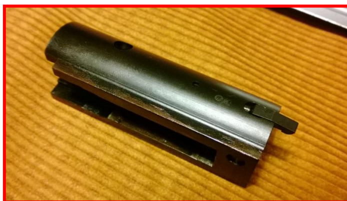
Il gruppo otturatore e percussore con in evidenza l'estrattore o unghia estrattrice.
