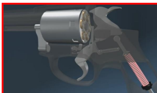
Il meccanismo di sgancio del cane
